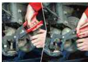
ボールジョイントブーツの取外し用に専用設計されたボールジョイントブーツプライヤ (AS412)
