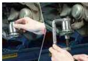
ボールジョイントブーツの圧入作業を簡単かつ確実に行えるボールジョイントブーツインサーターセット (ATS4110)
